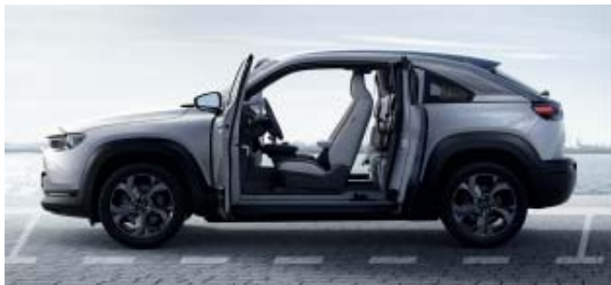
Portes « Freestyle » avec angle d'ouverture de 82°
